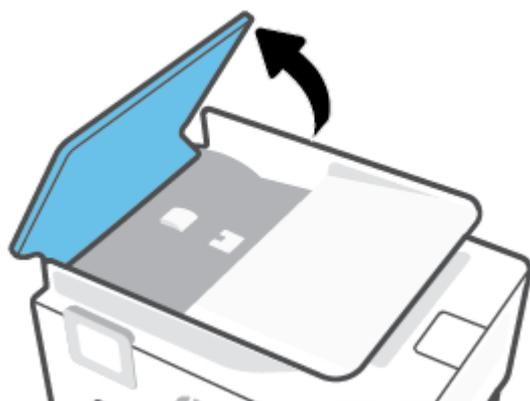
Takto získáte snadný přístup k válečkům (1) a oddělovacímu bloku (2).
