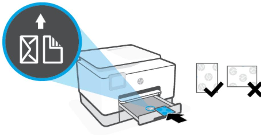
Ujistěte se, že je stoh papíru zarovnan s odpovídající čarou formátu papíru na přední straně zásobníku. Kromě toho se ujistěte, že stoh papíru nepřesahuje označení výšky stohu na levém okraji zásobníku.
