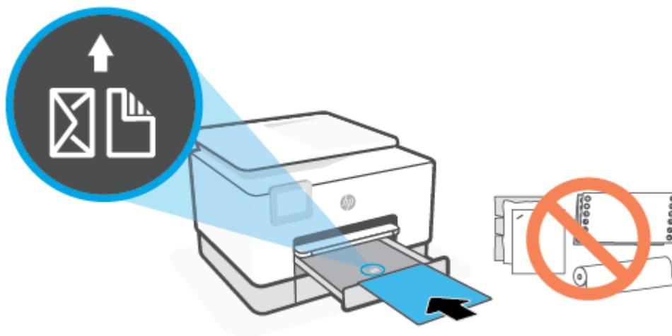
Ujistěte se, že je stoh papíru zarovnan s odpovídající čarou formátu papíru na přední straně zásobníku. Kromě toho se ujistěte, že stoh papíru nepřesahuje označení výšky stohu na levém okraji zásobníku.
