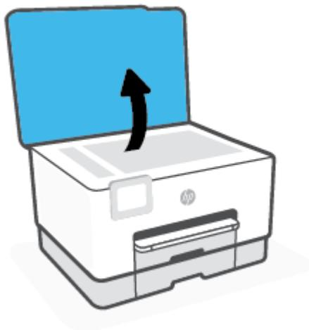
2. Vložte předlohu tiskovou stranou dolů a zarovnejte ji se značkou v zadním levém rohu skla.
