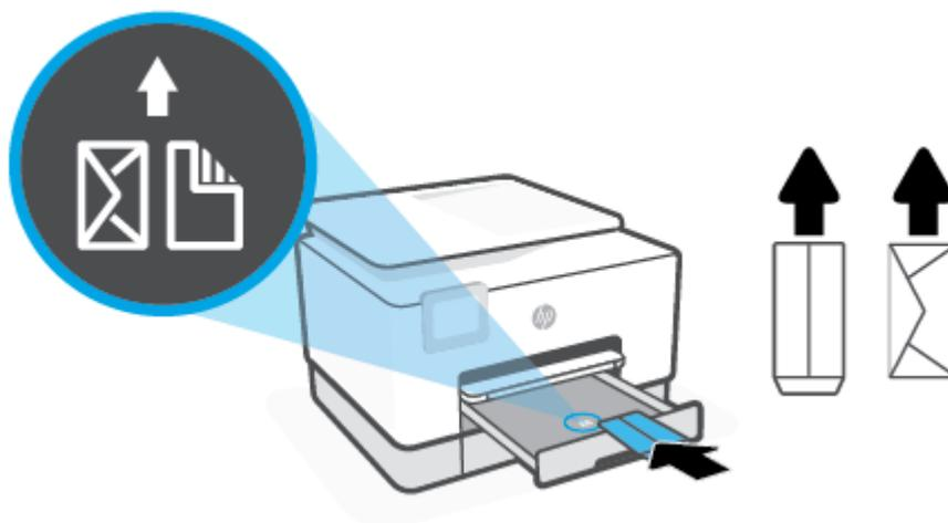
Ujistěte se, že je stoh papíru zarovnan s odpovídající čarou formátu papíru na přední straně zásobníku. Kromě toho se ujistěte, že stoh papíru nepřesahuje označení výšky stohu na levém okraji zásobníku.
