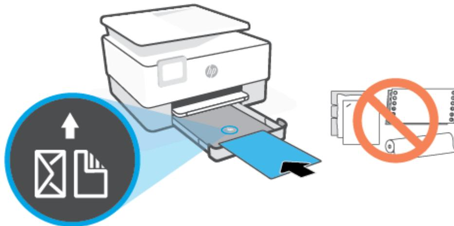
Vergewissern Sie sich, dass der Papierstapel an den entsprechenden Papierformatlinien an der Vorderseite des Fachs ausgerichtet ist. Stellen Sie darüber hinaus sicher, dass der Papierstapel die Markierung für die Maximalhöhe des Stapels auf der linken Kante des Fachs nicht überschreitet.
