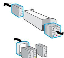
**ZHTW** 打開前擋門，接著透過掃描器蓋板抬起墨水匣存取擋門。打開墨水匣包裝。
