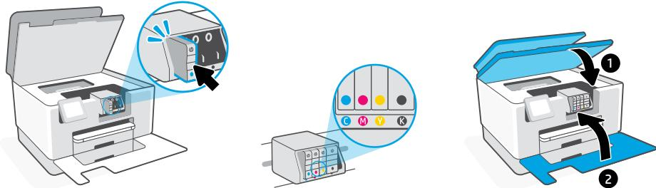
**ZHTW** 將各個墨水匣穩固地插入指定的插槽中。將兩個擋門關上。
