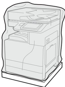
Retire la impresora, el tambor de creación de imágenes, la unidad de recogida de tóner (TCU) y el resto del hardware de la caja. Después de quitar el embalaje de la impresora y los accesorios, permita que se adecúen al entorno durante cuatro horas.
