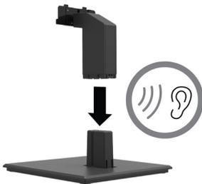
3. Stecken Sie die beiden Riegel am Ständer in die Halterung an der Rückseite des Monitorkopfes, bis sie hörbar einrasten.
