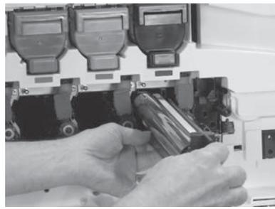
Setzen Sie die Bildtrommel ein, indem Sie diese an der Vertiefung an der Oberseite der Trommeleinheit an der Führung am oberen Rand der Öffnung ausrichten.
