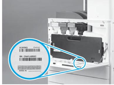
Nehmen Sie das Etikett mit dem Barcode von dem Schild mit der Modellbezeichnung und bringen Sie das Etikett mit dem neuen Barcode innen an der vorderen Abdeckung des Druckers an.
