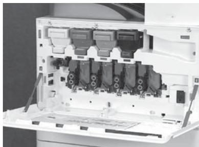
Drehen Sie am Triebwerk die Verriegelung der Bildtrommel nach unten und entfernen Sie dann alle orangefarbenen Transportsiegel.
