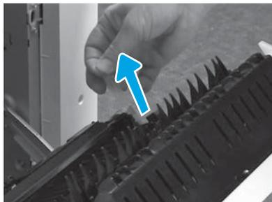
Entfernen Sie vorsichtig das Verpackungsband an der Rückseite der Transfereinheit.
