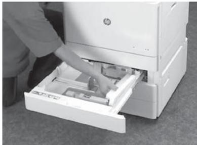
Öffnen Sie Fach 2- 3 und entfernen Sie alle Transportbänder und das Verpackungsmaterial aus Schaumstoff.
