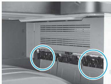
Installieren Sie die Papierhandhabungsführungen an zwei Positionen am ersten Ausgang.
