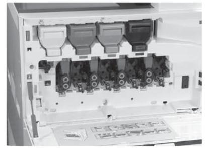
Drehen Sie die Verriegelung der Bildeinheit der Trommel nach oben, damit diese einrasten kann. Setzen Sie die übrigen Bildeinheiten der Trommeln ein. Vergewissern Sie sich, dass alle Verriegelungshebel NACH OBEN zeigen und alle Verschlüsse für die Tonerversorgung OFFEN sind.
