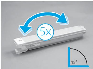
Entfernen Sie die Verpackung von der Tonerpatrone. Schütteln Sie die Patrone seitlich fünfmal (5) durch, damit sich der Toner in der Patrone verteilt.
