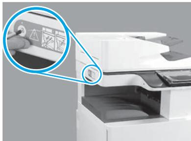
Entfernen Sie die Verriegelungsschraube am Scanner und den roten Aufkleber auf der linken Seite des Druckers.
