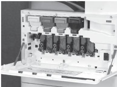
Ruotare il blocco dell'unità fotosensibile nel motore verso il basso, quindi rimuovere ogni inserto arancione di spedizione.
