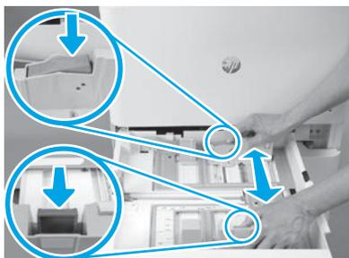
Premere sulla linguetta blu sulla parte posteriore del vassoio. Premere allo stesso tempo la linguetta blu sulla parte anteriore del vassoio e far scorrere per regolare sulla lunghezza della carta appropriata. Entrambe le linguette sono caricate a molla e si bloccheranno una volta rilasciate.
