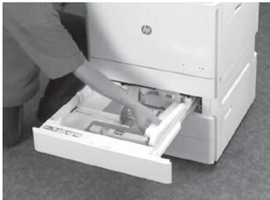
Aprire il vassoio 2-3 e rimuovere completamente il nastro e il materiale di imballaggio in gomma espansa.
