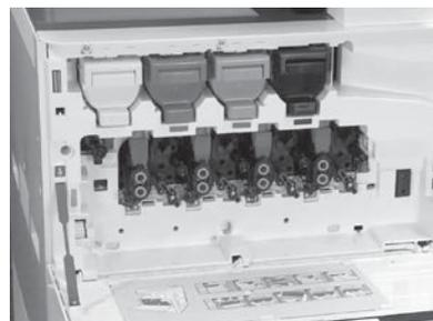
Ruotare il fermo del tamburo dell'unità fotosensibile verso l'ALTO per bloccare l'unità fotosensibile in posizione. Installare i restanti tamburi delle unità fotosensibili. Verificare che ciascuna leva di blocco sia rivolta verso l'ALTO e che tutti gli shutter per l'erogazione del toner siano APERTI.
