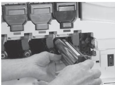
Installare il tamburo fotosensibile allineando la scanalatura sulla parte superiore dell'unità tamburo alla guida nella parte superiore dell'apertura.
