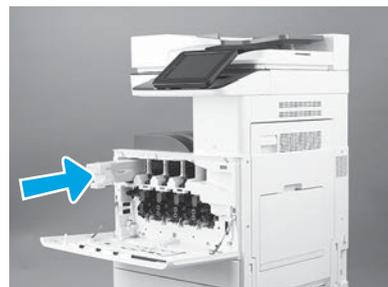
Use a codificação de cor na impressora para instalar o cartucho de toner no slot correto. Empurre-o para encaixar por completo no cartucho.
