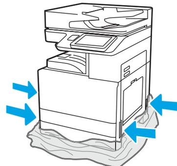
Empurre o plástico transparente protetor para baixo da base da impressora para permitir acesso a pontos de levantamento.
