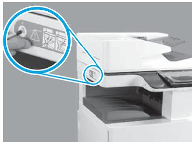
Remova o parafuso de trava do scanner e o adesivo vermelho no lado esquerdo da impressora.
