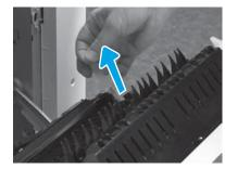
Осторожно удалите обвязочную ленту с задней части узла переноса.
