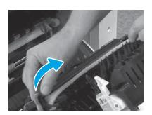
Осторожно удалите обвязочную ленту с передней части узла переноса.
