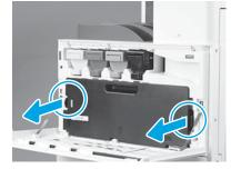
Нажмите на защелки с каждой стороны TCU и снимите TCU.
