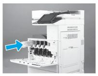
Используйте цветовую кодировку на принтере для установки картриджа с тонером в правильный слот. Задвиньте картридж до упора.
