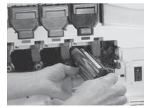
Установите блок формирования изображений: для этого совместите паз, расположенный на верхней части барабана, с направляющей в верхней части отверстия.
