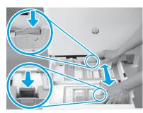
Нажмите и удерживайте синий ограничитель в задней части лотка. Одновременно зажмите синий ограничитель в передней части лотка и придвиньте его к краю листа для регулировки длины бумаги. Оба ограничителя оснащены пружинами и зафиксируют свое положение, когда вы их отпустите.
