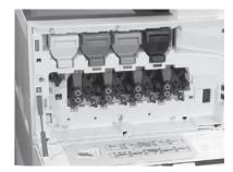
Поднимите блокирующий рычажок блока формирования изображения ВВЕРХ для фиксации положения блока формирования изображения. Установите остальные барабаны передачи изображений.
