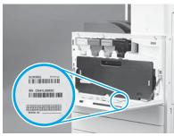
Найдите штрихкод, соответствующий табличке устройства, и нанесите новую этикетку со штрихкодом с внутренней стороны передней крышки принтера.
