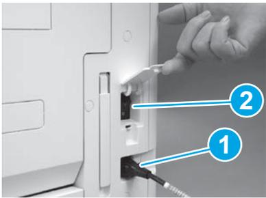
Collegare il cavo di alimentazione alla stampante e alla presa a muro (richiamo 1).
