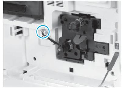
Collegare il connettore dell'unità di imaging al connettore del motore.
