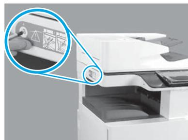
Rimuovere la vite di blocco dello scanner e l'adesivo rosso sul lato sinistro della stampante.
