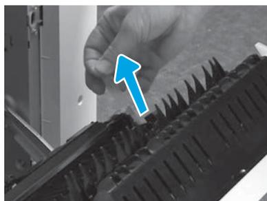
Rimuovere con cautela il nastro per reggiatura nella parte posteriore dell'unità di trasferimento.
