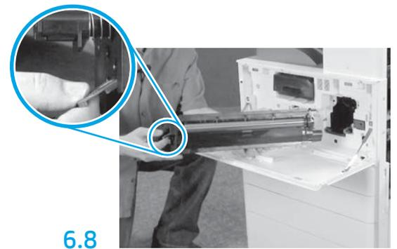
Con una mano, tenere l'unità di imaging dalla parte inferiore, e con l'altra tenere la maniglia grigia sul lato anteriore.
