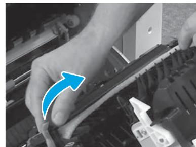
Rimuovere con cautela il nastro per reggiatura nella parte anteriore dell'unità di trasferimento.
