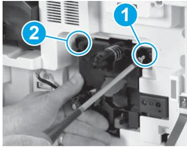
Tenere l'unità di imaging in posizione durante l'installazione della prima vite (richiamo 1) per fissare l'unità. Installare la seconda vite (richiamo 2).
