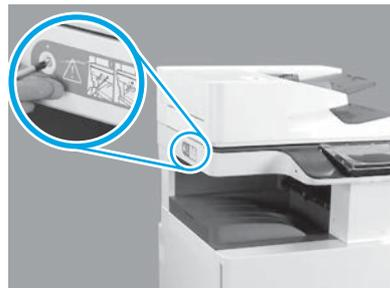
取下打印机左侧的扫描仪锁螺钉和红色贴纸。
