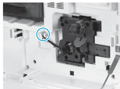
**6.11** 将成像装置接口连接到引擎接口。
