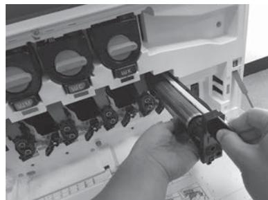
Setzen Sie die Bildtrommeleinheit ein, indem Sie diese an der Vertiefung an der Oberseite der Trommeleinheit an der Führung am oberen Rand der Öffnung ausrichten.
