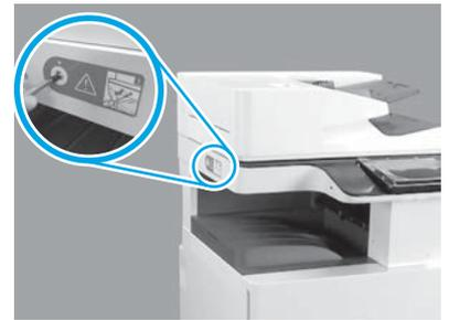
Entfernen Sie die Verriegelungsschraube am Scanner und den roten Aufkleber auf der linken Seite des Druckers.
