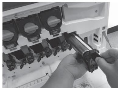
Installare l'unità tamburo fotosensibile allineandone la scanalatura sulla parte superiore alla guida nella parte superiore dell'apertura.
