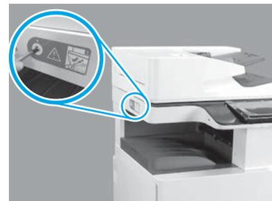
Rimuovere la vite di bloccaggio dello scanner e l'adesivo rosso sul lato sinistro della stampante.
