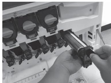
Барабан құралы үстіндегі ойықты саңылау үстіндегі бағыттауышпен туралау арқылы кескіндеу жабдығын барабанын орнатыңыз.
