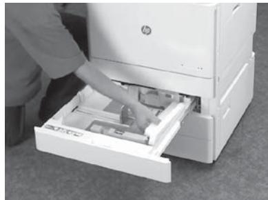
打開 2-3 號紙匣，然後拆除所有的膠帶和泡棉包裝材料。
