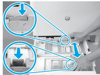
Appuyez sur la languette bleue située à l'arrière du bac. Pincez ou pressez la languette bleue située à l'avant du bac en même temps et faites coulisser pour ajuster selon la longueur du papier. Les deux languettes sont à ressort et se bloquent lorsqu'elles sont relâchées.
