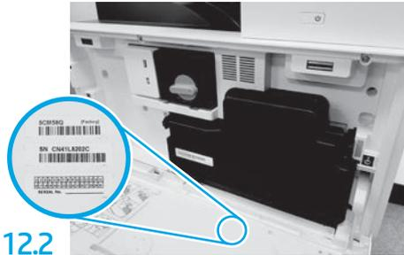
Suchen Sie den der Modellbezeichnung entsprechenden Barcode und bringen Sie das Etikett mit dem neuen Barcode innen an der vorderen Abdeckung des Druckers an.
