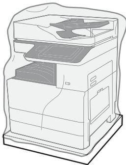
Nehmen Sie den Drucker, die Bildtrommel, den Tonerauffangbehälter (TCU) und die dazugehörige Hardware aus der Kiste. Geben Sie dem Drucker und dem Zubehör nach dem Auspacken mindestens 4 Stunden Zeit, sich der Umgebungstemperatur anzupassen.
