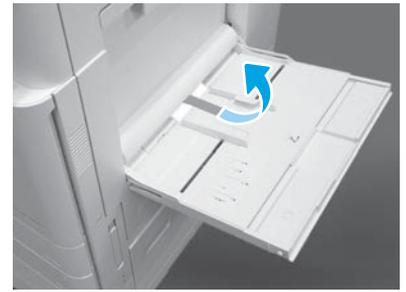
Öffnen Sie Fach 1 an der rechten Seite des Druckers und entfernen Sie dann den Schaumstoff neben der Einzugschwabe.
