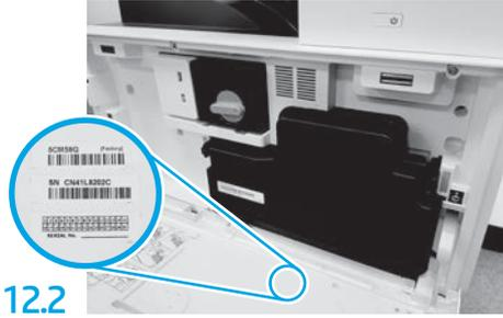
找到与型号铭牌匹配的条码，然后将新条码标签安装在打印机前盖内侧。
