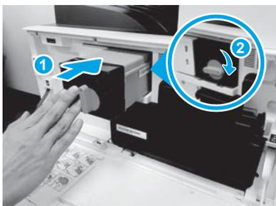
Вставьте картридж с тономером в соответствующее гнездо и задвиньте его в принтер (выноска 1). Затем заблокируйте защелку (выноска 2).
