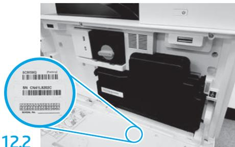
Найдите штрихкод как на табличке с указанием модели и поместите новую наклейку со штрихкодом на внутреннюю поверхность передней крышки принтера.
