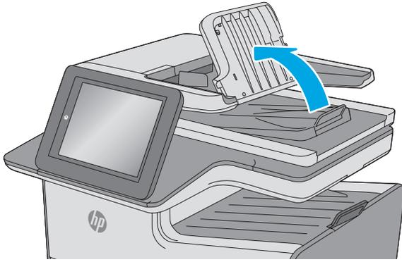
Heben Sie das Zufuhrfach des Vorlageneinzugs an.
