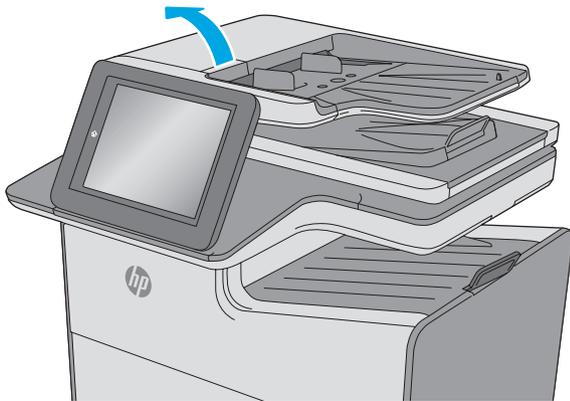
Heben Sie die Verriegelung an, um die Vorlageneinzugsabdeckung zu lösen.
