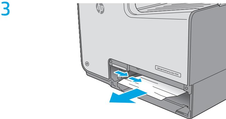
Entfernen Sie jegliches gestaute Papier aus den Zufuhrwalzen im Drucker. Ziehen Sie das Papier zunächst nach links und dann nach vorn, um es herauszuziehen.
