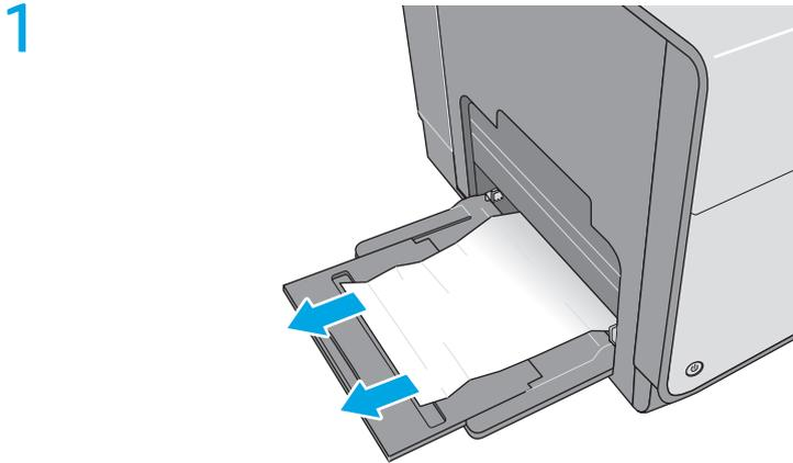
Entfernen Sie eingeklemmtes Papier aus Fach 1.
