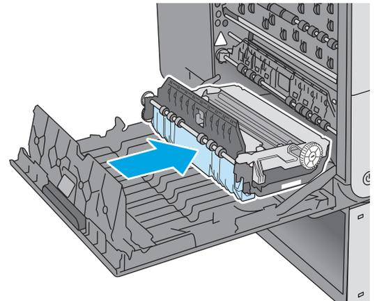
Setzen Sie die Tintenauffangeinheit ein.
