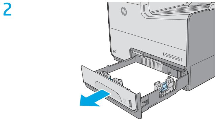
Ziehen Sie Fach 2 vollständig aus dem Drucker heraus, indem Sie daran ziehen und es leicht anheben.
