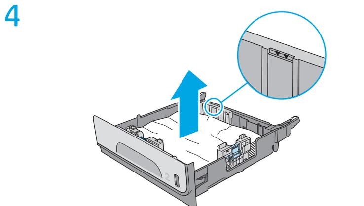
Entfernen Sie eingeklemmtes oder beschädigtes Papier. Vergewissern Sie sich, dass das Fach nicht überfüllt ist und die Papierführungen richtig ausgerichtet sind.
