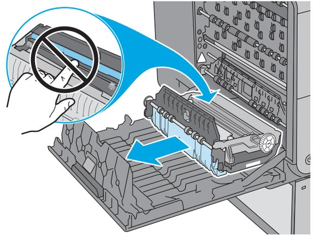
Entfernen Sie die Tintenauffangeinheit, indem Sie sie mit beiden Händen herausziehen. Legen Sie die Einheit aufrecht auf einem Stück Papier zur Seite, um Tintenleckse zu vermeiden.
