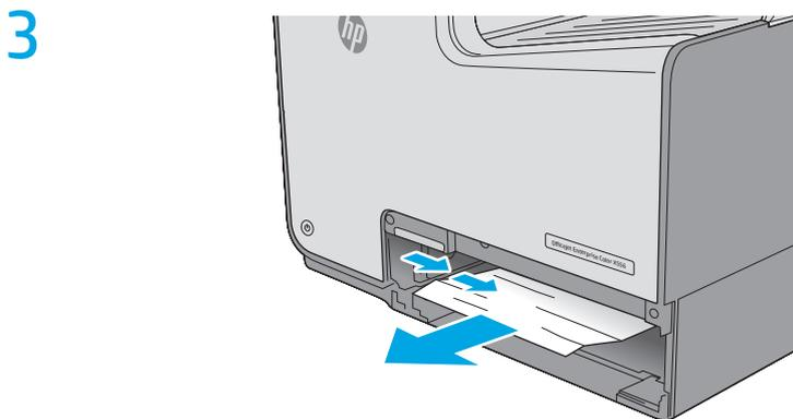
プリンタ内部のフィードローラーに詰まった用紙を取り除きます。まず用紙を右側に引き、次に前方に引いて取り除きます。
