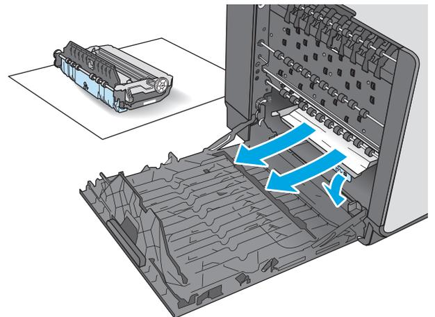
緑色のタブを押し下げてプラテンを下に下げます。これにより、プリンタは印刷ゾーンを通じて給紙しようとしません。給紙されない場合は、用紙を軽く引いてみてください。用紙を取り出します。
