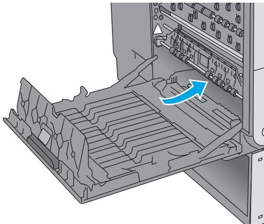
インク回収ユニットを取り外してから、インク回収ユニットが取り付けられていた場所を奥まで覗いて、見つかった用紙やゴミをすべて取り除きます。
