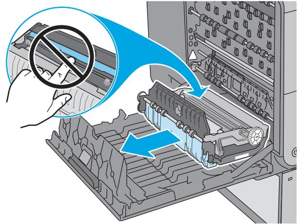
インク回収ユニットを両手で手前に引いて取り外します。インクがこぼれないように、インク回収ユニットを紙の上に乗せすぐに立てて置きます。
