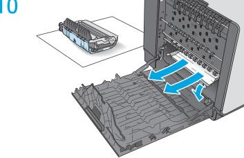
通过向下按绿色压片, 放下压板。这将使打印机尝试通过打 印区进纸。如果未能进纸,则可能需要轻轻地拉动这张纸。 取出纸张。
