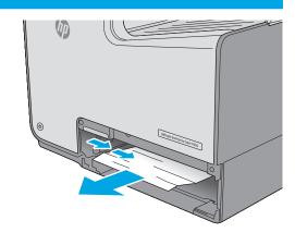
从打印机内部的进纸轮上取出任何卡住的纸张。首先将纸张 拉向右侧,然后向前拉出纸张。
