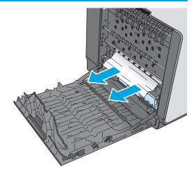
从滚轮和传送区轻轻拉出卡住的纸张。如果纸张被撕裂, 确保取出所有纸张碎屑。
