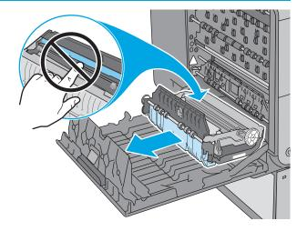
用双手拉出墨水收集装置以将其卸下。将装置竖着放在一张 纸上以防墨水溢出。
