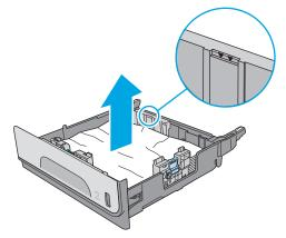
取出任何卡住或损坏的纸张。核实纸盘未装得太满,并且已正确调整纸张导板。
