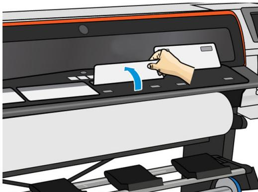
2. 素材をロールから少し引き出し、その先端を取り付けアクセサリの白い磁気フラップの下に置きます。
