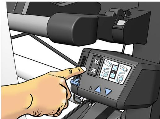
20. フロントパネルの【有効】ボタンをタップします。プリンタが素材を送り、キャリブレーションを行います。
