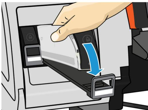
5. カートリッジを挿入した引き出しをスロットの中にスライドさせ、所定の位置に固定されるまで押し込みます。
