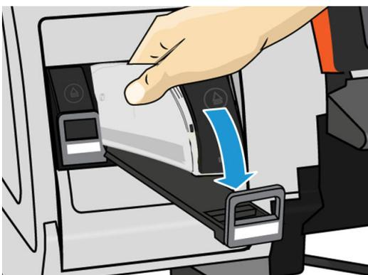
5. 中間タンクを挿入した引き出しをスロットの中にスライドさせ、所定の位置に固定されるまで押し込みます。
