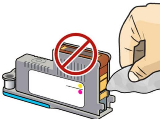
**△注意：** 破損しやすいため、ノズルがある面には触らないでください。
