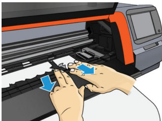
**△注意：**正常な方向とは逆の動作となり、プリンタ部品に損傷を与えるおそれがあるので、素材を入力経路から引き出さないようにしてください。
