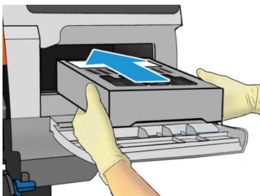
6. スロットから飛び出さないところまでメンテナンスカートリッジを押し込みます。プリンタが自動的に受け入れるので、無理矢理押し込まないでください。
