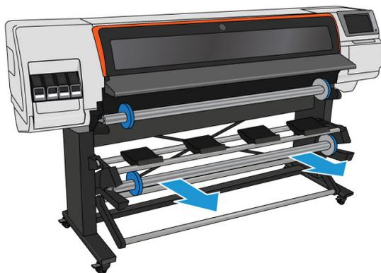
スピンドルの両端には、ロールを正しい位置に固定するストッパが付いています。左端の青いストッパを取り外し、新しいロールを取り付けます(必要に応じて、76 mm(3 インチ)径のスピンドルの右側ストッパも取り外せます)。ストッパは、スピンドルに沿ってスライドし、異なる幅のロール紙が固定できます。
