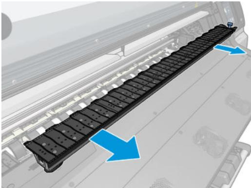
2. 将边缘固定夹放入压板模块或墨水收集器上，并调整好其位置：对于左侧，尽可能滑至最左侧；对于右侧，尽可能滑至最右侧。
