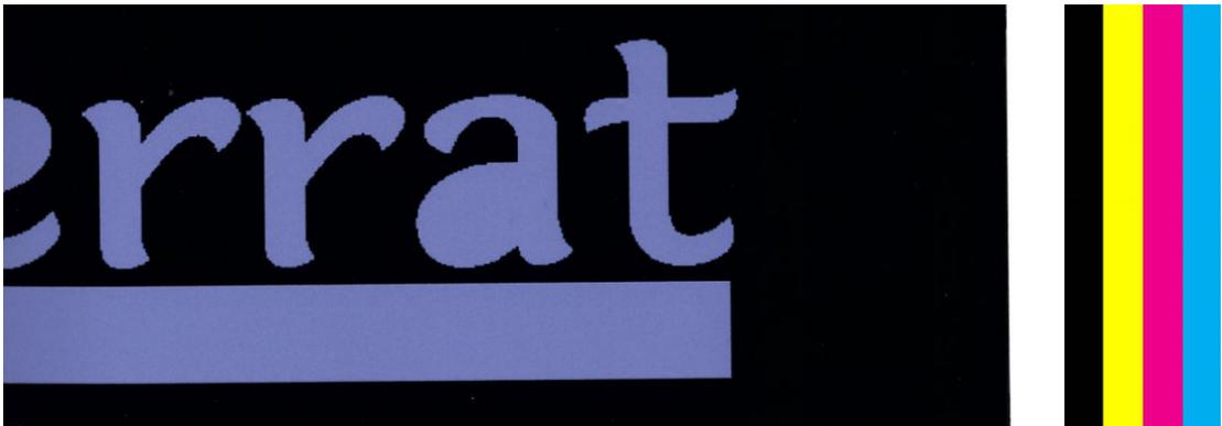
3. 在打印之前，手动向图像添加侧面颜色条。在这种情况下，可使用标准颜色，也可决定加入其中已发现问题的特定颜色。建议每个颜色条的宽度为 5 毫米。
