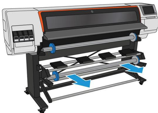
卷轴两端都有挡块，用于使纸卷处于正确位置。卸下位于左端的蓝色挡块，以安装新的卷筒（如果需要，也可以卸下直径为 76 毫米 卷轴另一端的挡块）。该挡块可在卷轴上滑动以固定不同宽度的卷筒。
