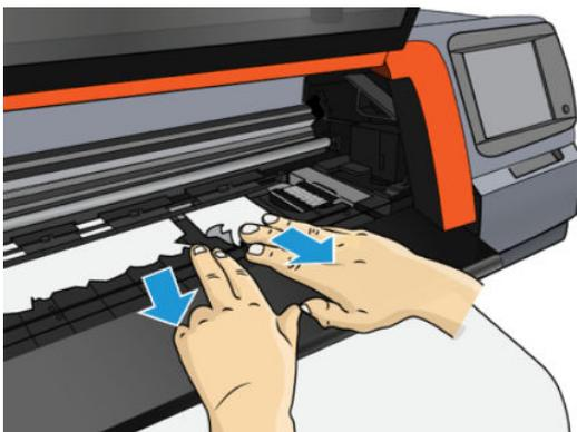
**⚠ 注意：** 尽量避免从进纸通道向外拉纸张，因为这样颠倒了正常的移动方向，因此可能会损坏打印机部件。
