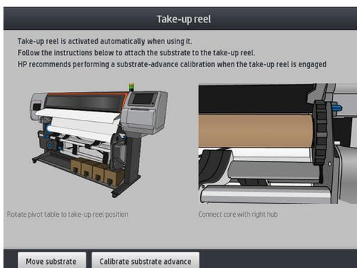
2. 如果决定在打印期间装入收纸器，请先熟悉该过程的各个步骤，然后再点击 **启用**按钮。在打印过程中装入收纸器要求您在打印机送出和打印纸张时完成此流程。在打印过程中装入收纸器可以节省大约 1.5 米长的纸张。
