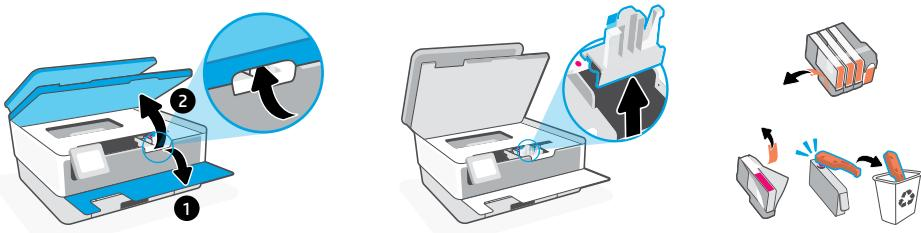
**FR** Ouvrez la porte avant, puis soulevez la porte d'accès aux cartouches au niveau du capot du scanner. Retirez la protection en plastique. Retirez l'emballage de la cartouche, le ruban et les protections de couleur orange.
