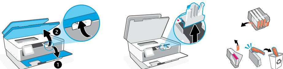
**NL** Open de voorklep en til de toegangsklep voor cartridges bij de scannerklep omhoog. Verwijder de plastic beveiliging. Verwijder de cartridgeverpakking, de tape en de oranje beveiligingen.
