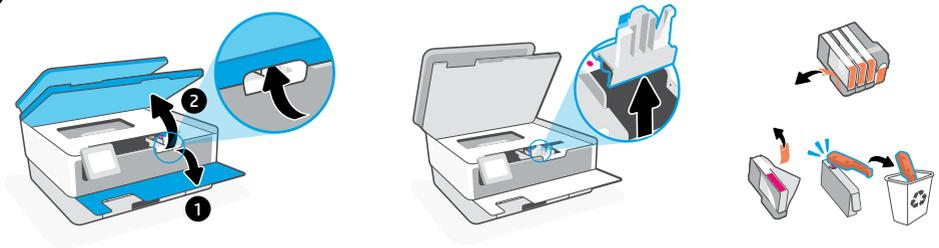
VI Mở cửa trước, rồi sau đó nhấc cửa tháo lắp hộp mực bằng nắp máy quét. Gỡ miếng bảo vệ bằng nhựa. Gỡ bỏ bao bì của hộp mực, băng dính và miếng bảo vệ màu cam.
