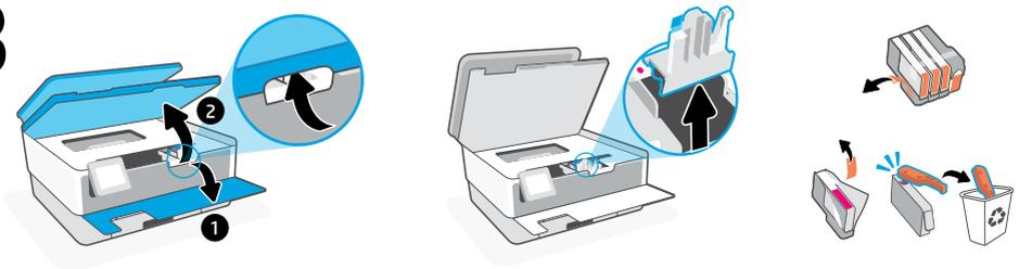
**ZHTW** 打開前擋門，接著透過掃描器蓋板抬起墨水匣存取擋門。取下塑膠固定片。取下墨水匣包裝、膠帶及橙色固定片。
