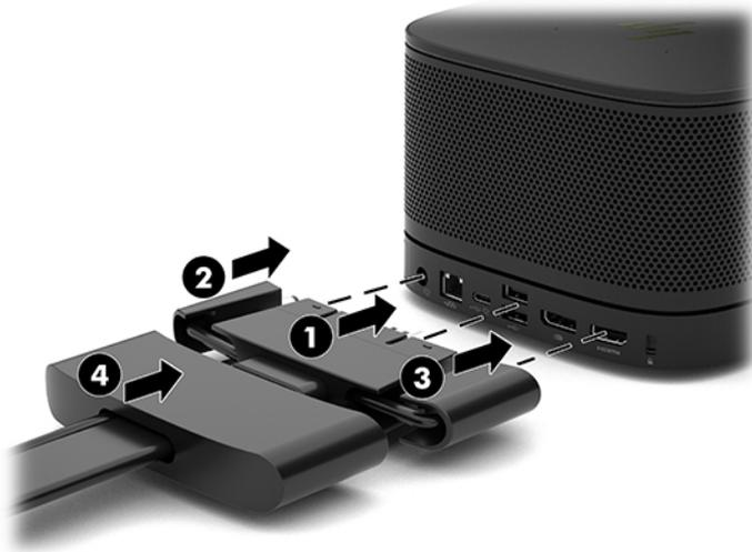
2. Collegare la restante apparecchiatura, ad esempio un modulo CoRC o un monitor, al coperchio dei cavi e delle porte.
