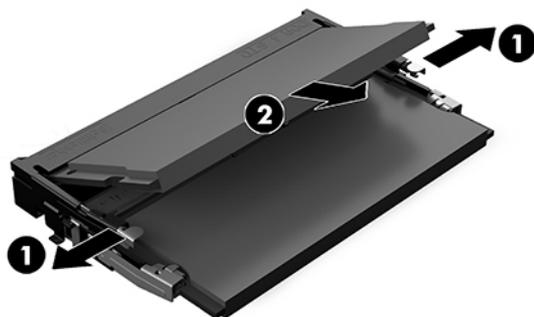
3. Inserire il nuovo modulo di memoria nello slot con un'angolazione di circa 30° (1), quindi spingerlo nello slot (2) in modo che le levette lo blocchino in posizione.
