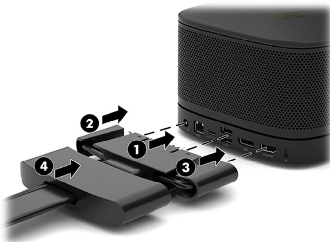
4. Se è installato il modulo Wireless Display, eseguire i passaggi riportati di seguito per installare il ricevitore wireless:
