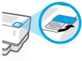
6. Inserire il Kit ricarica toner nella porta di ricarica e ruotarlo di mezzo giro in senso orario per bloccarla in posizione.
