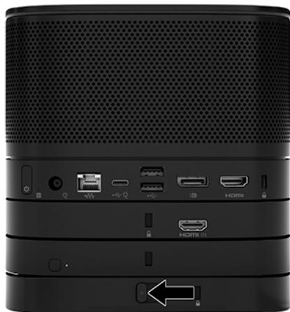
4. クイック リリース ラッチがロック解除されてモジュールが切り離されることを防ぐために、VESA マウント モジュールのセキュリティ ロック ケーブル用スロットにセキュリティ ロック ケーブルを取り付けます。
