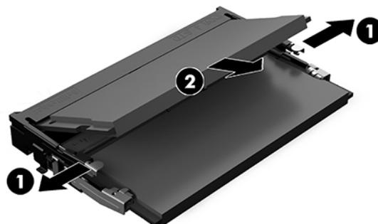
3. 新しいメモリ モジュールを約 30 度の角度でスロットに差し込み (1)、メモリ モジュールを押し下げて (2) ラッチを所定の位置に固定します。
