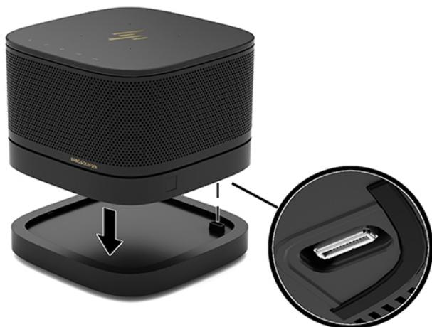
モジュールどうしがロックされる時、小さなクリック音が聞こえます。モジュールが所定の位置にロックされ、モジュールのリリースラッチはその下のモジュールで隠されます。
