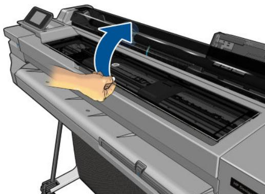
11. Levante la palanca del carro.
