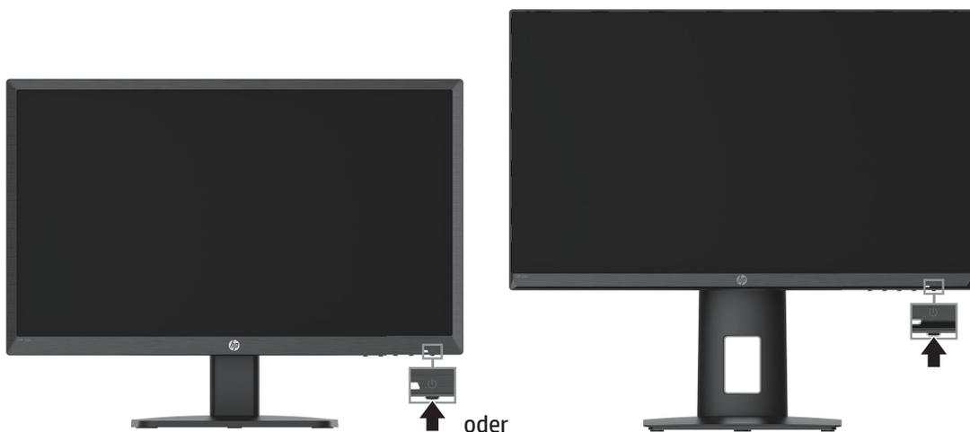
Wenn der Monitor zum ersten Mal eingeschaltet ist, wird fünf Sekunden lang eine Monitorstatus-Meldung angezeigt. Die Meldung zeigt den Eingang des aktuell aktiven Signals, den Status des automatischen Eingangswechsels (Ein oder Aus; Standardeinstellung ist Ein), die aktuell voreingestellte Anzeigeauflösung und die empfohlene voreingestellte Anzeigeauflösung.
