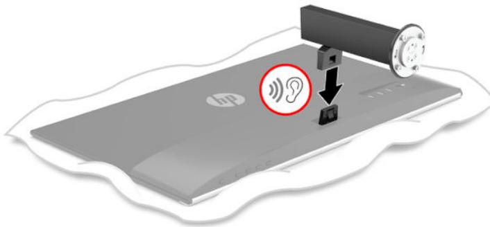
3. Befestigen Sie das Ende des Ständers an den Sockel (1) mit den Pfeilen (2) auf der Unterseite des Sockels und dem oberen Ende entsprechend ausgerichtet, drehen Sie den Sockel (3) nach links, und befestigen Sie dann den Sockel mit den beiden Rändelschrauben (4) am oberen Ende.
