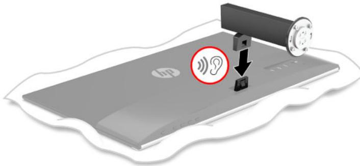
3. Fixez le collet du socle à la base (1) avec des flèches (2) sur la partie inférieure de la base et le collet aligné, faites pivoter la base (3) vers la gauche, puis fixez la base au collet avec les deux vis à serrage à main (4).
