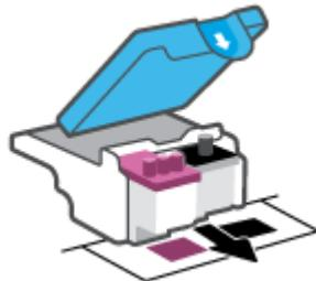
7. 清洁打印头触点和打印机触点。
