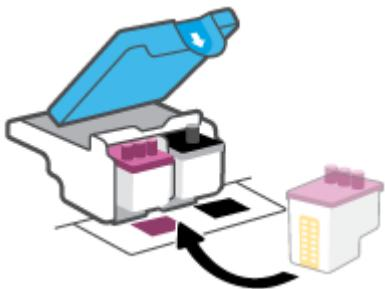
**9.** 关闭打印头卡销。确保打印头卡销正确关闭，以避免托架卡住等问题。
