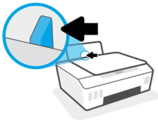
3. 将一个或多个信封紧靠进纸盒的最右侧放入，然后向下滑动整叠信封，直到不能移动为止。
