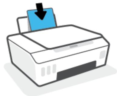
4. 向右滑动纸张宽度导轨，直到触及纸张边缘。
