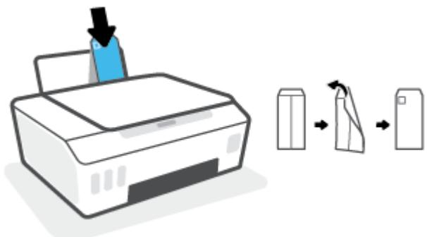
4. 向信封滑动纸张宽度导轨，直到停止为止。
