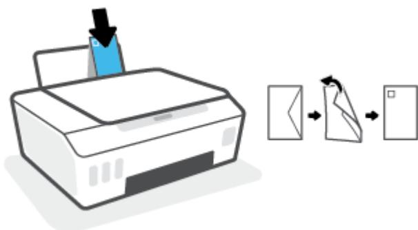
b. 对于封盖在短边一侧的信封，将信封垂直插入，使其封盖置于顶部，面朝下。
