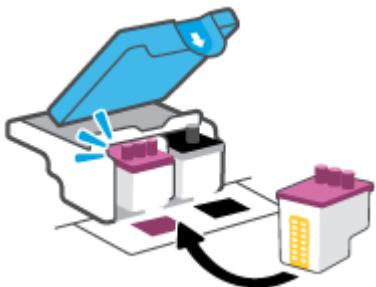
g. 关闭打印头卡销。确保打印头卡销正确关闭，以避免托架卡住等问题。
