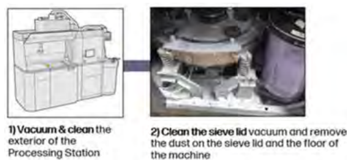
Abbildung 11-20 Wartungsarbeiten einmal jährlich
