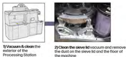
Figura 11-20 Operaciones de mantenimiento una vez al año
