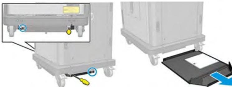
3. Videz la poudre accumulée dans le carter plat inférieur et nettoyez-le à l'aide d'un chiffon si nécessaire.
