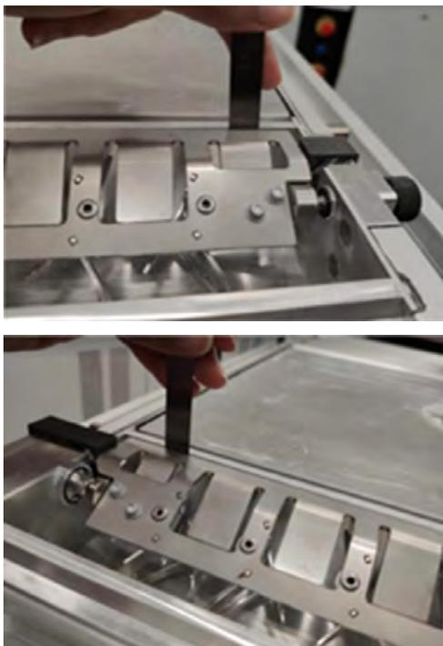
Vérifiez si l'écart est compris entre 0,3 et 0,8 mm tout le chemin. Ajustez si nécessaire en desserrant les 2 vis de chaque côté et à l'aide d'une jauge de 0,6 mm.
