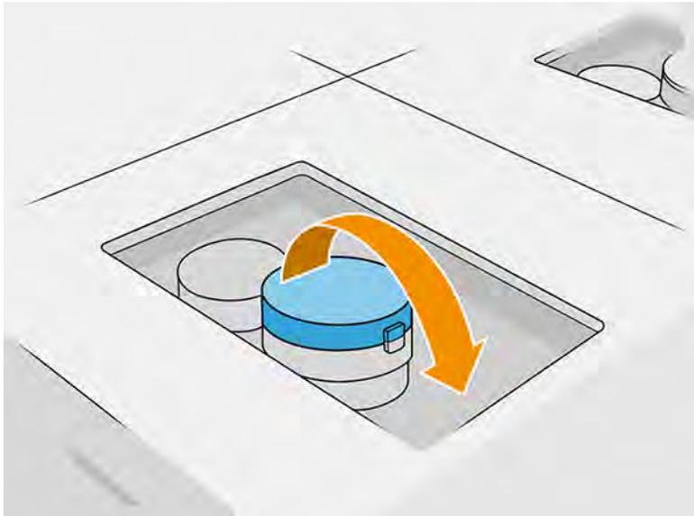
6. Retirez l'opercule situé sur l'embout avant.
