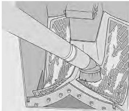
25. À l'aide d'une buse étroite, aspirez d'abord autour du maillage, puis les entrées de l'élévateur de matériau.
