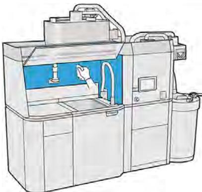
5. Nettoyez la tôle perforée, à l'écart la station de traitement, à l'aide d'un chiffon absorbant tout usage.
