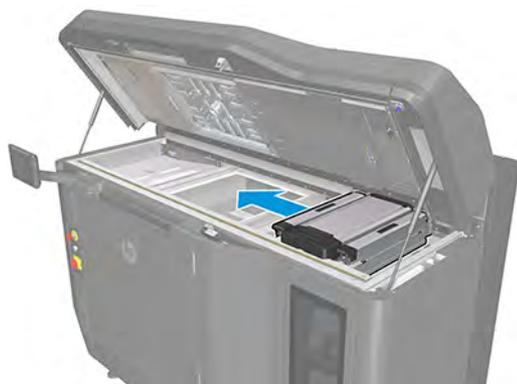
3. Déplacez le chariot sur le côté gauche et utilisez un matériau en mousse, en carton ou doux pour soulever légèrement le chariot, comme illustré dans l'image suivante.
