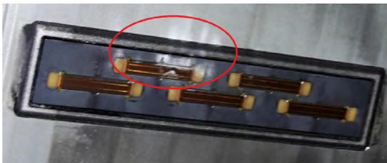
4. Retirez les têtes d'impression et inspectez les joints d'étanchéité des têtes d'impression par le haut.
