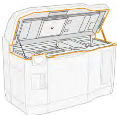
3. Aspirez le chariot d'impression et la zone de recouvrement en entier. Déplacez le chariot d'impression manuellement si nécessaire. En outre, vous pouvez utiliser un chiffon non pelucheux légèrement humidifié un produit de nettoyage industriel d'usage général pour nettoyer les surfaces. Assurez-vous que le chariot est sec avant d'imprimer.
