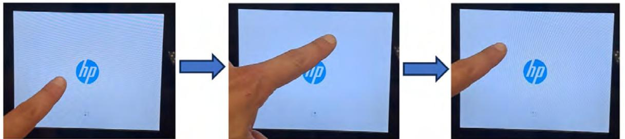
6. Après cinq secondes, si la séquence de diagnostics d'entrée réussit, l'imprimante démarre dans le mode de démarrage de diagnostics. Si la séquence échoue, l'imprimante démarre dans le mode de démarrage par défaut de l'imprimante.
