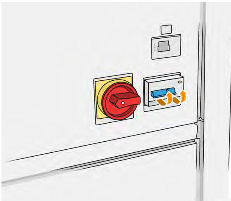
3. Mettez l'interrupteur en position sous tension.
