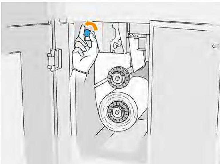
9. Mettez le matériel de nettoyage des têtes d'impression de côté afin de percevoir la lame en caoutchouc.
