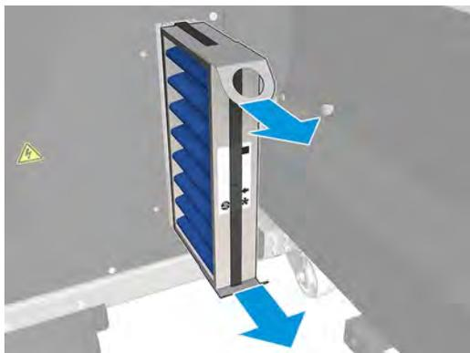
5. Installez le filtre en faisant attention à la flèche directionnelle du filtre (elle doit pointer à l'intérieur).
