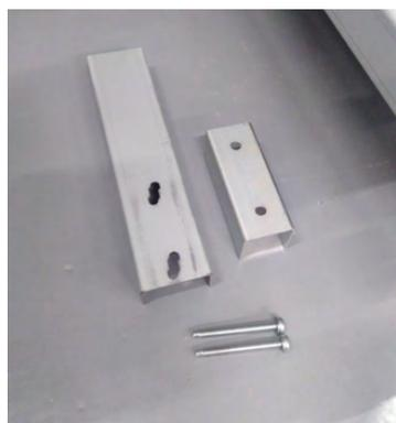
4. Fixez les nouvelles pièces de feuille métallique et le tube en forme de U avec les deux vis que vous venez de retirer. Ne serrez pas les vis tant que la procédure d'étalonnage n'est pas terminée.
