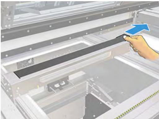
5. Aspirez toute la zone, y compris la zone de roulement à bille. Cela doit ressembler à l'image suivante une fois nettoyé correctement.
