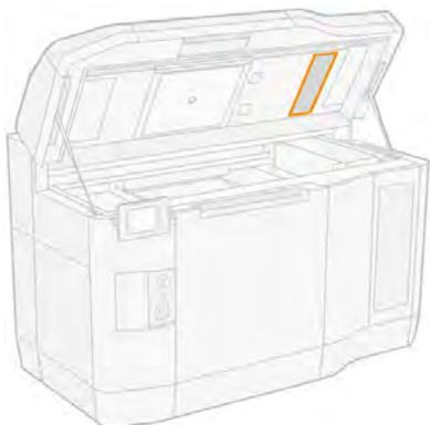
3. Retirez les six vis et faites glisser le dispositif du filtre.
