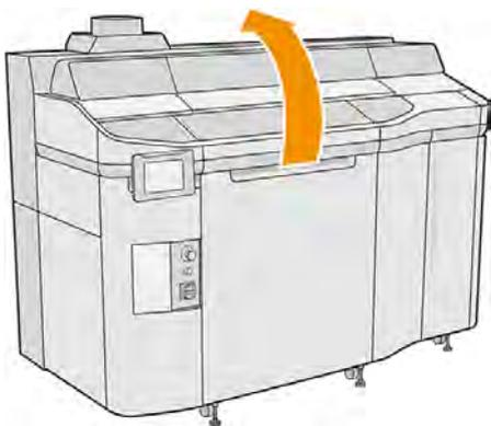
2. Repérez le filtre de la lampe de chauffage sur le côté droit du capot supérieur.
