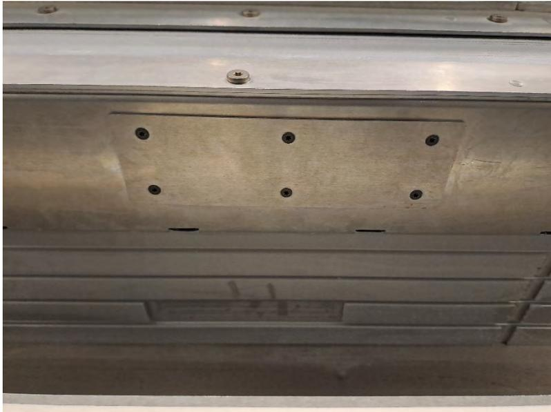
3. Vérifiez qu'il n'y a aucune ligne au-dessus du chariot de recouvrement après une tâche. Dans l'image suivante, certaines lignes indiquant une fuite potentielle d'air dans le capuchon de rideau sont visibles.
