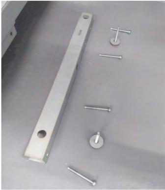
3. Assemblez le nouvel élément métallique et une pièce en feuille métallique avec une vis en position avant. Veillez à ne pas serrer la vis, car vous devrez peut-être rajouter des pièces de feuille métallique après l'étalonnage.
