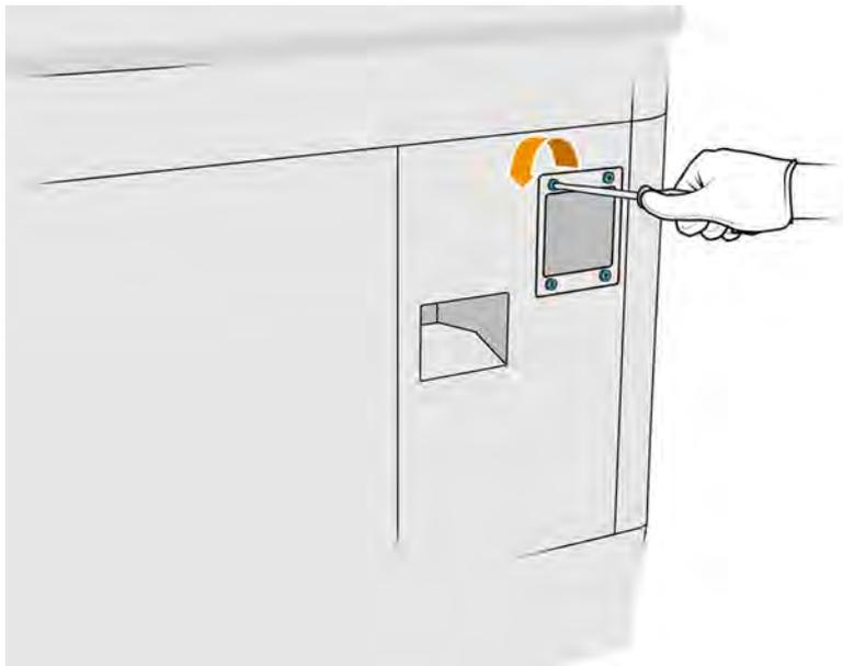
3. Retirez et mettez au rebut l'ancien filtre conformément aux réglementations locales, puis insérez le filtre neuf.
