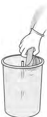
9. Insérez le filtre neuf entre le conteneur et le tube central, avec l'extrémité fermée vers le haut et l'extrémité ouverte vers le bas.
