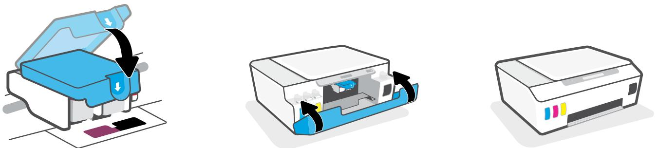
**RU** Установите печатающие головки. Закройте синий фиксатор и дверцы.
