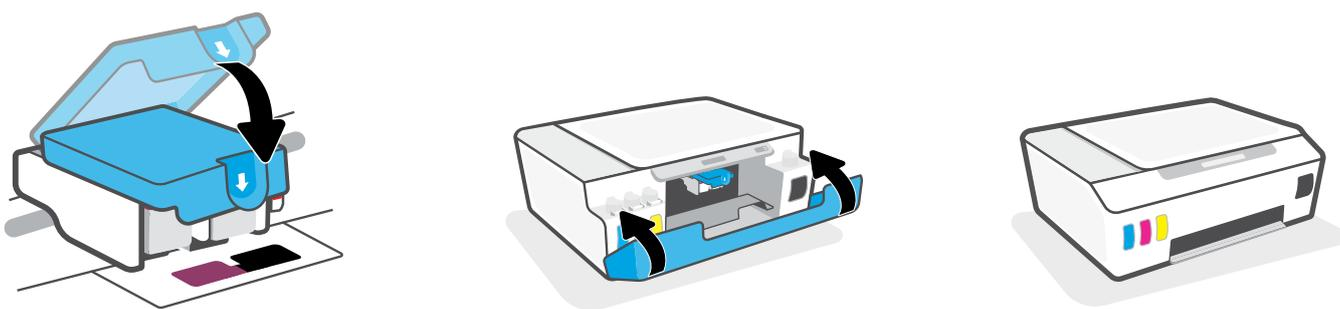
安装打印头。关闭蓝色卡销和墨槽门。
