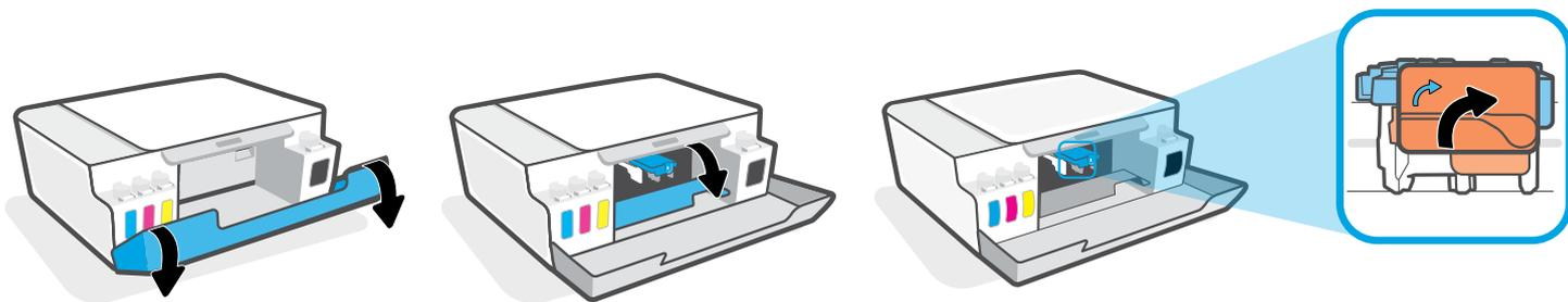
打开墨槽门。待托架移动到中心位置后停止。转动橙色手柄。
