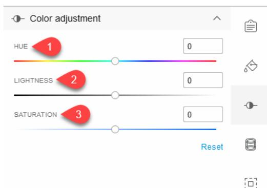
1. TONALIDADE: Arraste o indicador para a esquerda ou direita para ajustar a tonalidade da peça selecionada.
