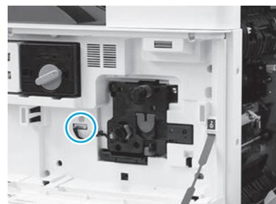
Verbinden Sie den Anschluss der Bildeinheit mit dem Anschluss der Maschine.
