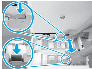
Drücken Sie den blauen Tab an der Rückseite des Faches nach unten. Drücken Sie oder quetschen Sie den blauen Tab im vorderen Bereich des Fach zusammen und schieben sie ihn zum Anpassen der Papierlänge. Beide Tabs sind federbelastet und verriegeln sich, sobald sie losgelassen werden.
