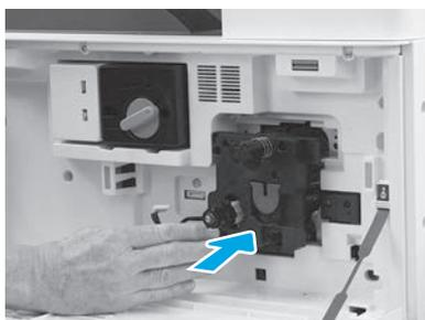
Schieben Sie die Bildeinheit in das Gerät ein.
