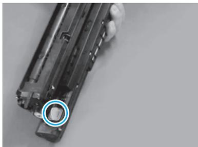
Entfernen Sie den orangefarbenen Abschluss von der Bildeinheit. Ziehen Sie eine Flügelschraube fest.
