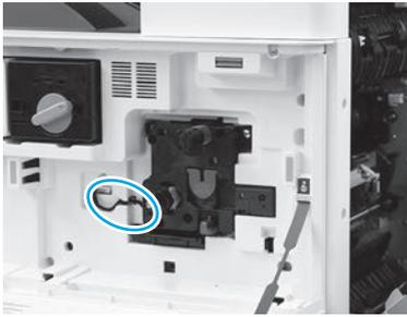
Führen Sie das Kabel durch den Kanal zwischen der Bildeinheit und dem Anschluss, und schließen Sie dann die rechte Klappe.
