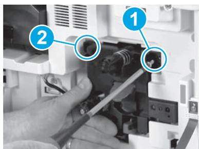
Drücken Sie auf die Bildeinheit und halten Sie an der richtigen Position beim Einsetzen der ersten Schraube fest (Abb. 1), um die Bildeinheit zu sichern. Setzen Sie die zweite Schraube (Abb. 2) ein.
