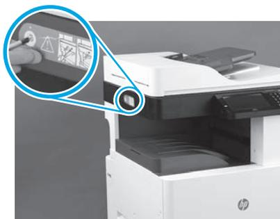
Rimuovere la vite di blocco dello scanner e l'adesivo rosso sul lato sinistro della stampante.
