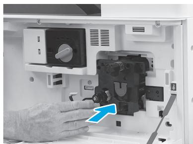
**6.10** 按成像装置并将其固定到位，同时安装第一个螺钉（图注1）以固定成像装置。安装第二个螺钉（图注2）。
