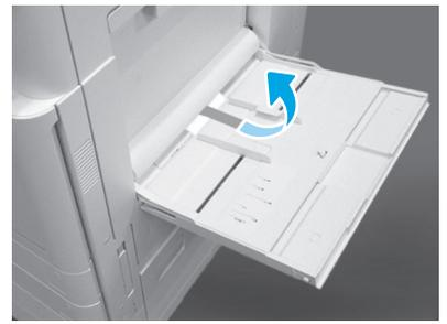
打开打印机右侧的纸盘 1，然后取下拾纸轮附近的泡沫。
