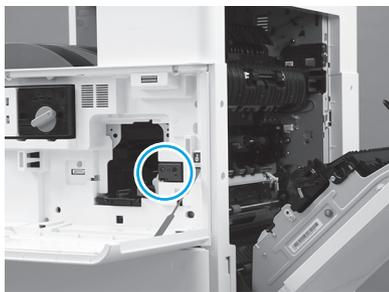
**6.1** 确保前挡盖和右挡盖打开。右挡盖缩回互锁杆，以便可安装成像装置。
