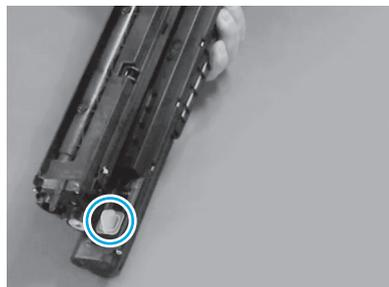
**6.7** 直着拉动红色箭头压片以揭下成像装置正面的封条。
