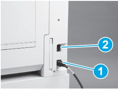
Conecte o cabo de alimentação à impressora e o receptáculo da parede (legenda 1).
