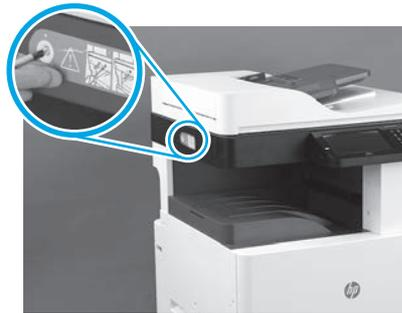
Remova o parafuso de trava do scanner e o adesivo vermelho no lado esquerdo da impressora.
