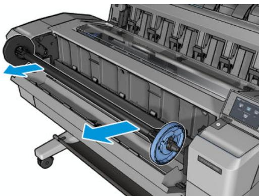
3. Die Spindel besitzt an beiden Enden einen Anschlag. Der blaue Anschlag kann entlang der Spindel verschoben werden und hat eine Verriegelung, mit der er festgestellt werden kann. Lösen Sie die Verriegelung des blauen Anschlags am Ende der Spindel, und nehmen Sie ihn ab.
