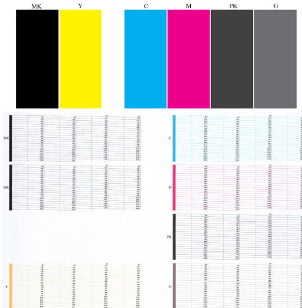
Überprüfen Sie zuerst den oberen Teil (Teil 1). Jedes Farbfeld muss eine einheitliche Deckung aufweisen. Es dürfen keine horizontalen Streifen vorhanden sein.
