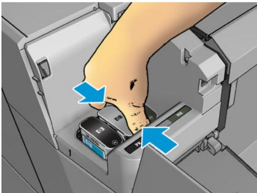
4. Ziehen Sie die Tintenpatrone gerade nach oben aus der Halterung.
