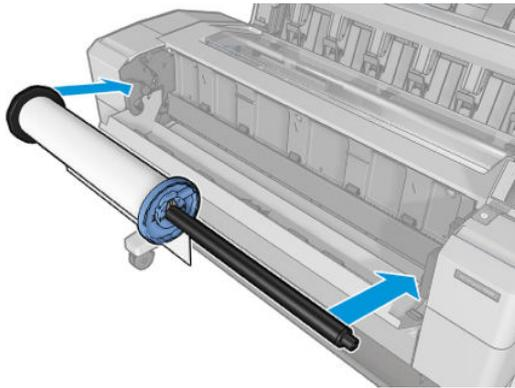
5. Wenn die Vorderkante der Rolle eingerissen (aufgrund des Klebebands, mit dem viele Rollen gesichert sind) oder nicht gerade ist, ziehen Sie das Druckmaterial ein Stück heraus, und schneiden Sie es gerade ab.
