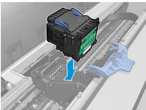
3. Überprüfen Sie, ob der Druckkopf im Verhältnis zu den Tintenanschlüssen richtig ausgerichtet ist.
