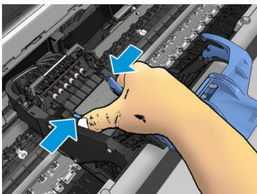
8. Ziehen Sie den Druckkopf aus dem Druckwagen heraus.
