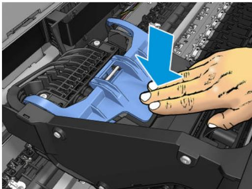
Wenn der Druckkopf ordnungsgemäß eingesetzt wurde und vom Drucker akzeptiert wird, ertönt ein Signalton.
