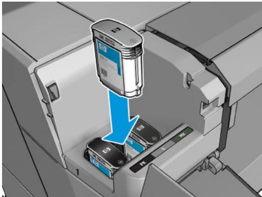
4. Drücken Sie die Tintenpatrone in den Steckplatz, bis sie einrastet. Sie müssen einen Signalton hören und auf dem Bedienfeld die Bestätigung sehen, dass die Patrone eingesetzt ist.
