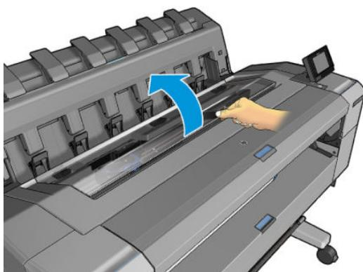
3. Der Druckwagen wird nun automatisch auf die linke Seite des Druckers gefahren.
