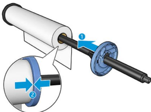
8. Schieben Sie den blauen Anschlag so weit wie möglich nach innen. Schließen Sie die Verriegelung, wenn beide Anschläge an den Rollenden anliegen.
