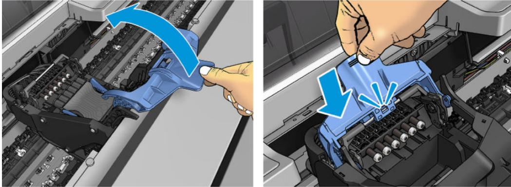
5. Schließen Sie die blaue Abdeckung und vergewissern Sie sich, dass diese vollständig geschlossen ist.
