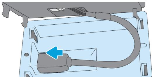
7. Richten Sie die hakenförmigen Clips des HP Jetdirect aus und setzen Sie sie in den HIP2 ein, drücken Sie den HP Jetdirect dann vorsichtig auf die abgerundeten Clips, bis er sicher an seinem Platz gehalten wird.
