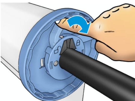
Wenn Sie regelmäßig unterschiedliche Druckmaterialsorten verwenden, können Sie die Rollen schneller wechseln, indem Sie jede Sorte auf eine eigene Spindel aufbringen. Die zusätzlichen Spindeln sind bei HP erhältlich (siehe [„Verbrauchsmaterial und Zubehör“ auf Seite 143](#)).
