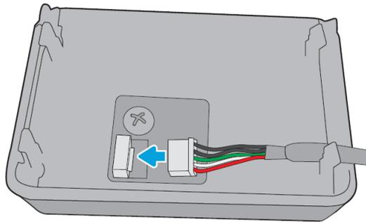
6. Verbinden Sie das USB Typ-A (flache) Ende des Kabels mit dem Anschluss im Inneren des HIP2.
