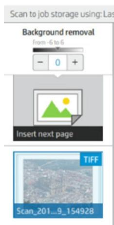
Eliminación de fondo detallada le permite ajustar con precisión el resultado de la eliminación inteligente de fondo cuando esté activada, o establecer manualmente el nivel de eliminación de fondo cuando la eliminación inteligente está desactivada en cualquier tipo de original. Puede definir estos valores en una escala de más oscuro a más claro en valores entre -6 y +6. El valor predeterminado de ambas opciones es cero.
