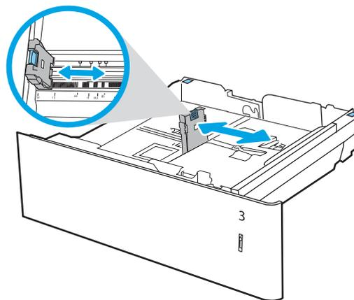
4. Pour tous les formats de papier suivants, réglez également le levier bleu d'arrêt du papier situé dans le coin arrière gauche du bac dans la bonne position, comme indiqué par l'étiquette du bac :
