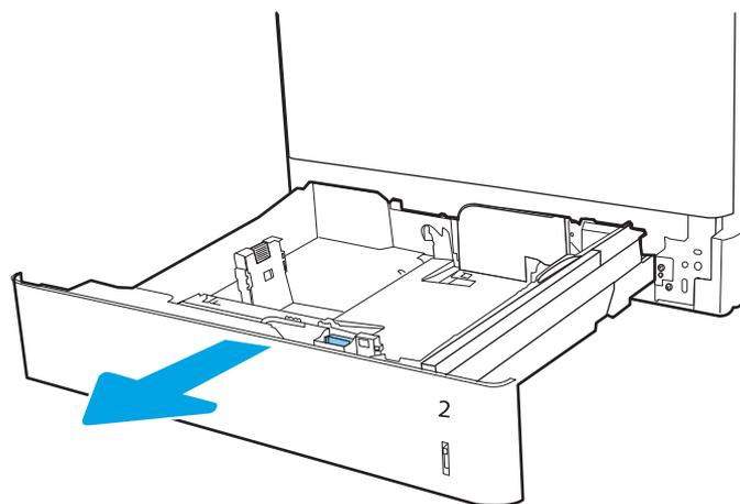
2. Avant de charger le bac, réglez les guides de largeur en appuyant sur les loquets de réglage bleus et en faisant glisser les guides jusqu'au format du papier utilisé.
