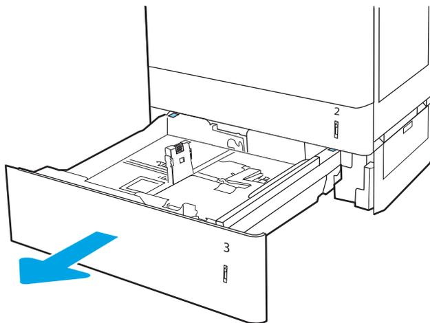
2. Avant de charger le bac, réglez les guides de largeur en appuyant sur les loquets de réglage bleus et en faisant glisser les guides jusqu'au format du papier utilisé.
