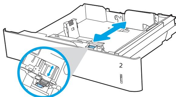
3. Réglez le guide de longueur du papier en appuyant sur le loquet de réglage du guide et en faisant glisser le guide jusqu'à ce qu'il atteigne le format du papier utilisé.
