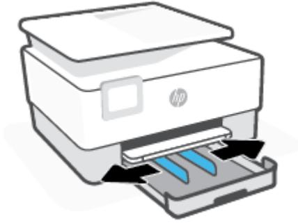
3. Introduzca las tarjetas de papel fotográfico en orientación vertical y con la cara que se va imprimir hacia abajo.
