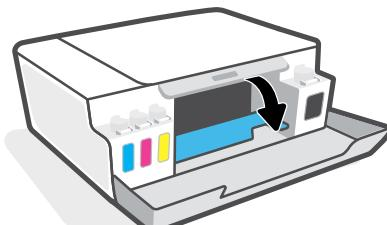
**DE** Vordere Klappe und dann die Druckkopf-Zugangsklappe öffnen.
