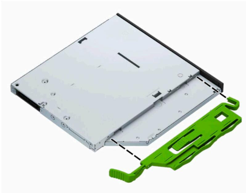
5. Schieben Sie das optische Laufwerk durch die Frontblende vollständig in den Schacht hinein (1), bis es einrastet (2).
